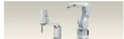
Робототехніка: робот SCARA, маніпулятор шарнірної конструкції
